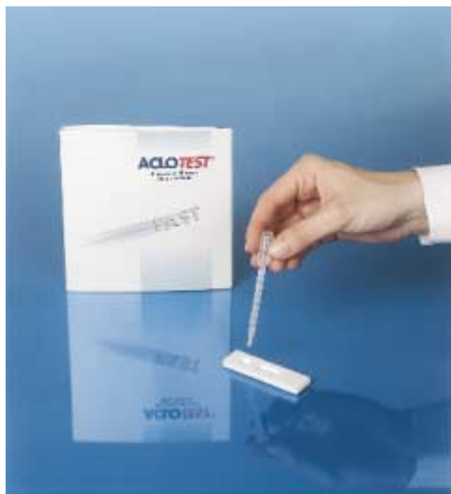
Figura 3: Esecuzione del test: dopo 10 minuti di incubazione si preleva nella provetta mediante l'apposita pipetta un certo volume di liquido e tre gocce dello stesso vengono aggiunte nell'apposito pozzetto della card
